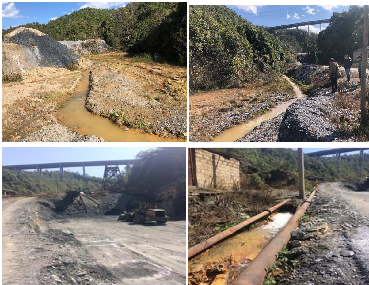
图 2.9-1 刺竹箐铅锌采矿场矿洞涌水
